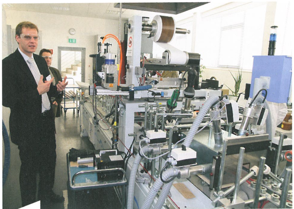
HotCoating-Folierung im Versuchslabor: Kleiberit hat im eigenen Forschungszentrum eine Folierungsanlage aufgebaut (links im Bild: Jens Fandrey von Kleiberit).
